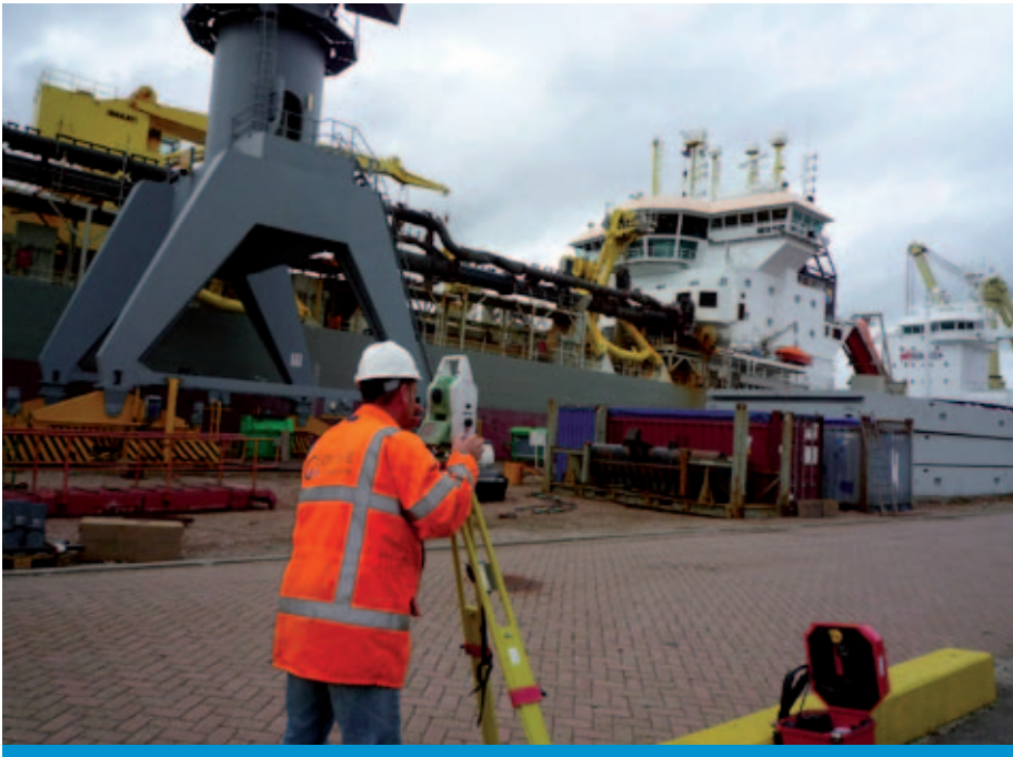
Scheepsgeometrie: gyrokalibratie en gps health check (foto Geovisie).
