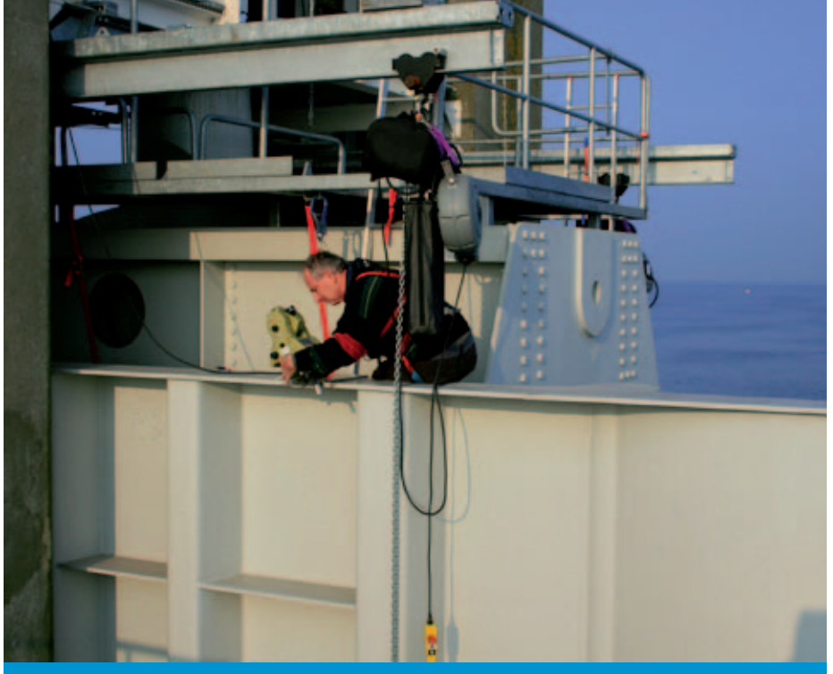
Schuine instrumentopstelling voor het meten van de vlakheid van schuifaanslagen in de Oosterscheldkering (foto Geovisie).
